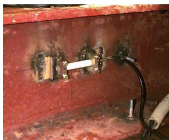
Датчик КМ устанавливают на стальную поверхность вместе с дополнительным фиксатором КМФ-22-100 методом сварки.
